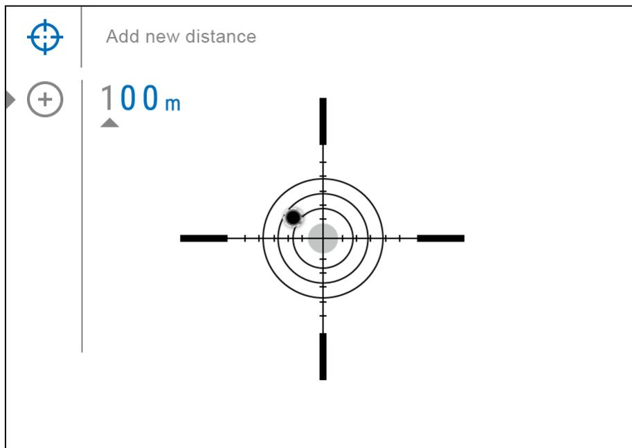
Para ajustar el tiro del visor, en primer lugar usted debe añadir la distancia de reglaje de tiro en el rango de 1 a 910 m.
