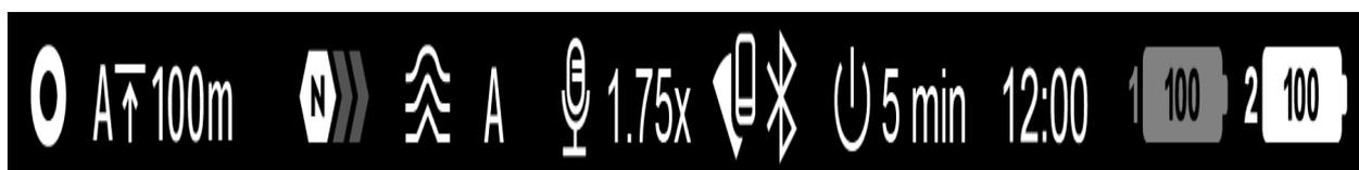
1. Si hay dos baterías en el dispositivo, se muestran dos pictogramas de batería en la barra de estado (1-batería incorporada, 2-baterías extraíbles). La batería del dispositivo se muestra en gris y blanco, inactiva en gris.
