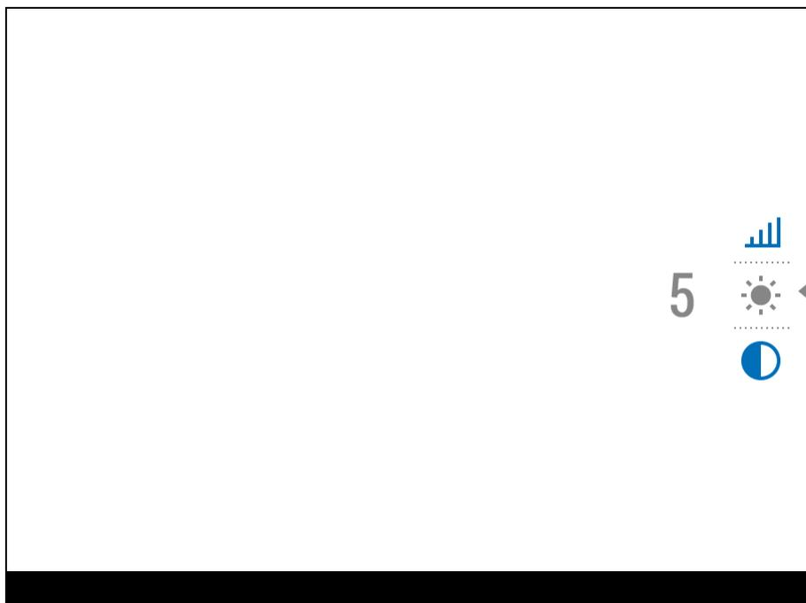
**Luminosità** ☀️ - premere i tasti **UP (10)** / **DOWN (8)** per modificare la luminosità del display da 0 a 20.
