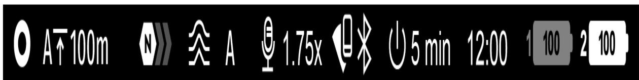
1. S'il y a deux batteries dans l'appareil, deux icônes de batterie sont affichées dans la barre d'état (1 batterie intégrée, 2 batteries amovibles). La batterie de l'appareil est affichée en gris et blanc, et en gris lorsqu'elle n'est pas utilisée.
