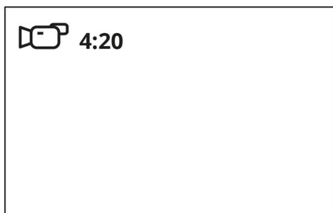
La commutation (transition) entre les modes de fonctionnement de la vue s'effectue par une pression longue du bouton **REC (4)**. Le changement des modes est cyclique (**Vidéo**-> **Photo**-> **Vidéo** ...).
