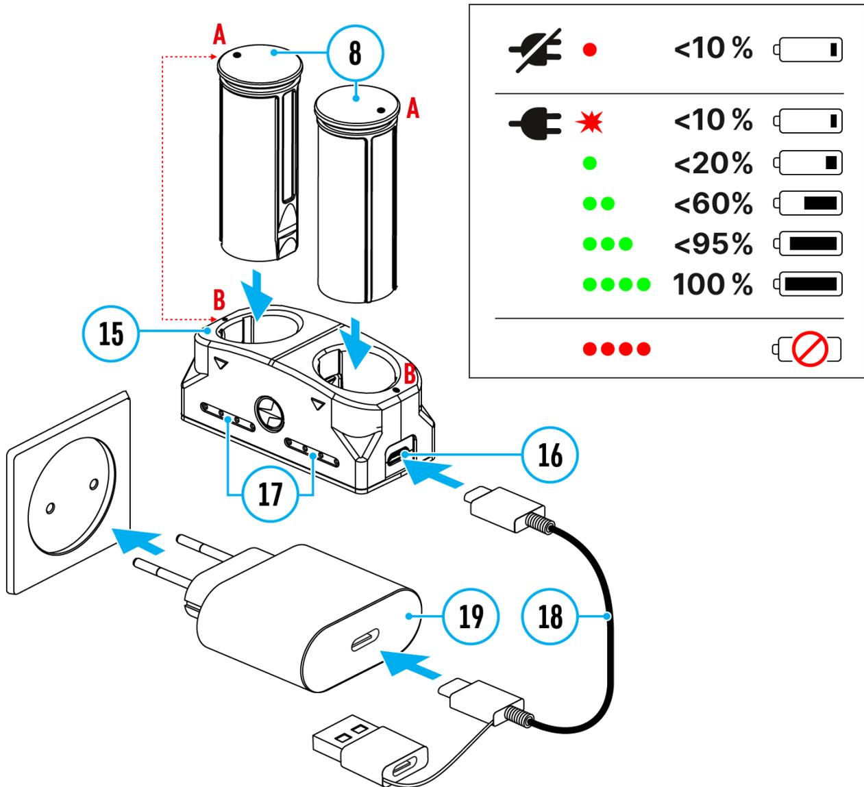
1. Insérez la batterie **(8)** tout au long du guide dans la fente du chargeur APS **(15)** fournie avec votre appareil ou vendue séparément.
