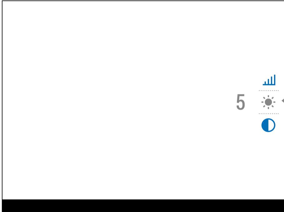
**Helligkeit** ☀️ - Drücken Sie die Tasten **UP (4) / DOWN (2)**, um die Bildhelligkeit von 0 bis 20 zu ändern.
