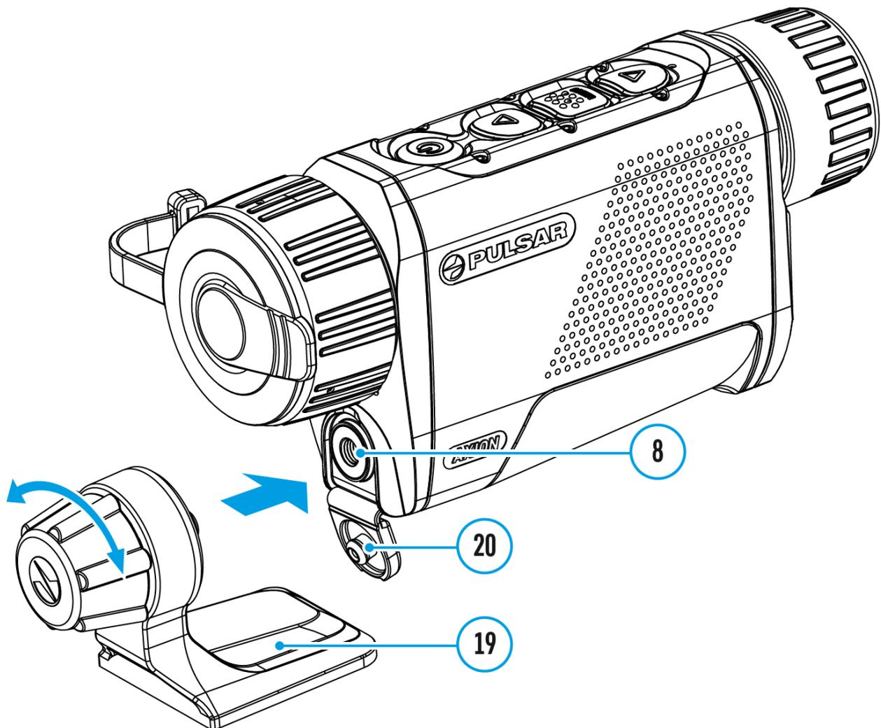
1. Öffnen Sie die Abdeckung **(20)** der Befestigungsbuchse **(8)**.
