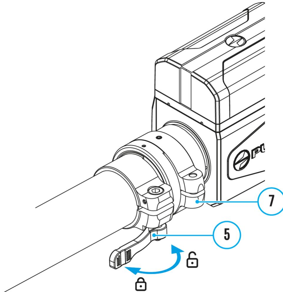
1. Lösen Sie die Schraube **(7)** mit einem Inbusschlüssel ( $S = 4 \text{ mm}$ ).
