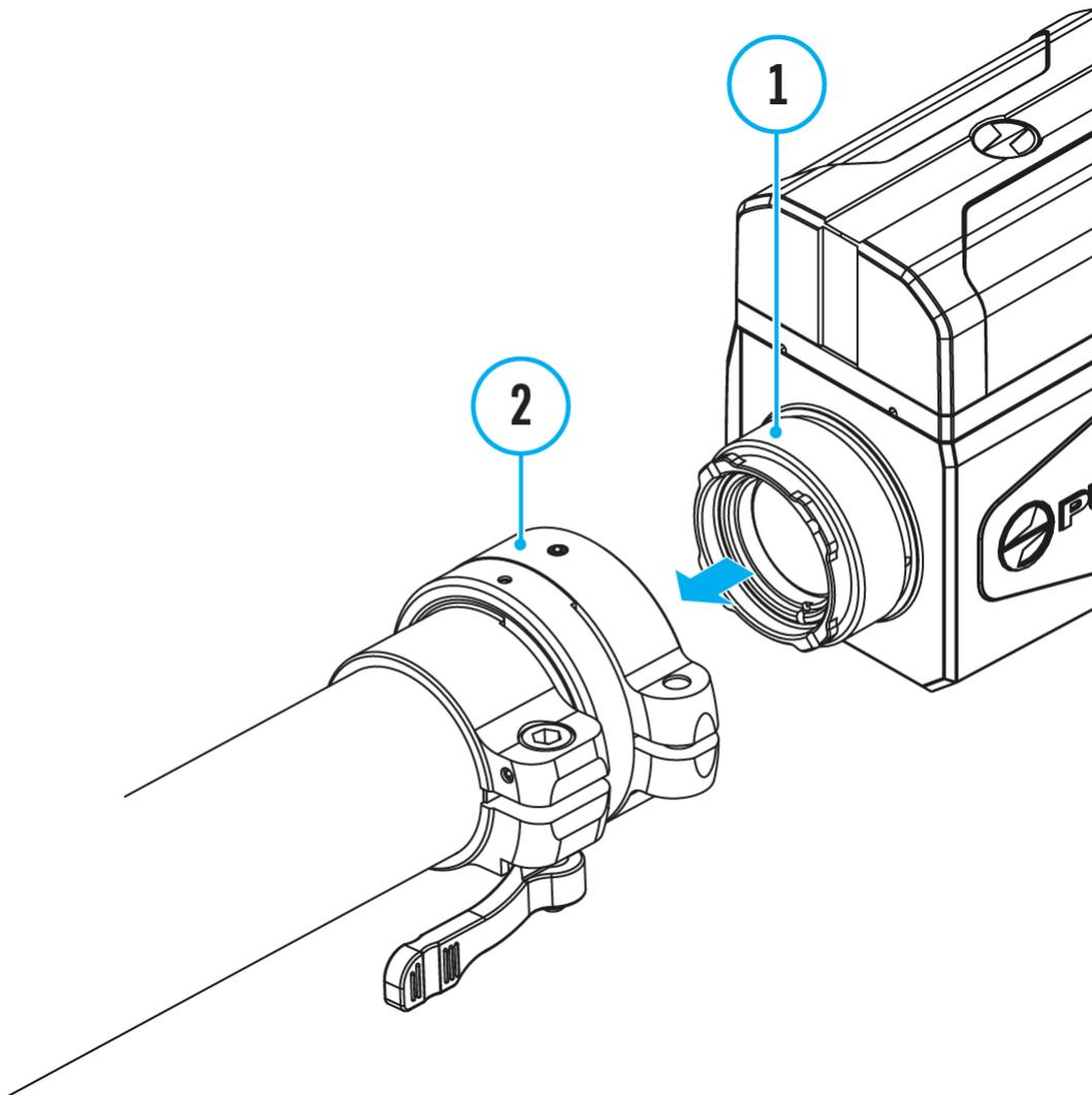
**1.** Entfernen Sie die Schutzabdeckung des Okulars des Wärmebildmoduls.
