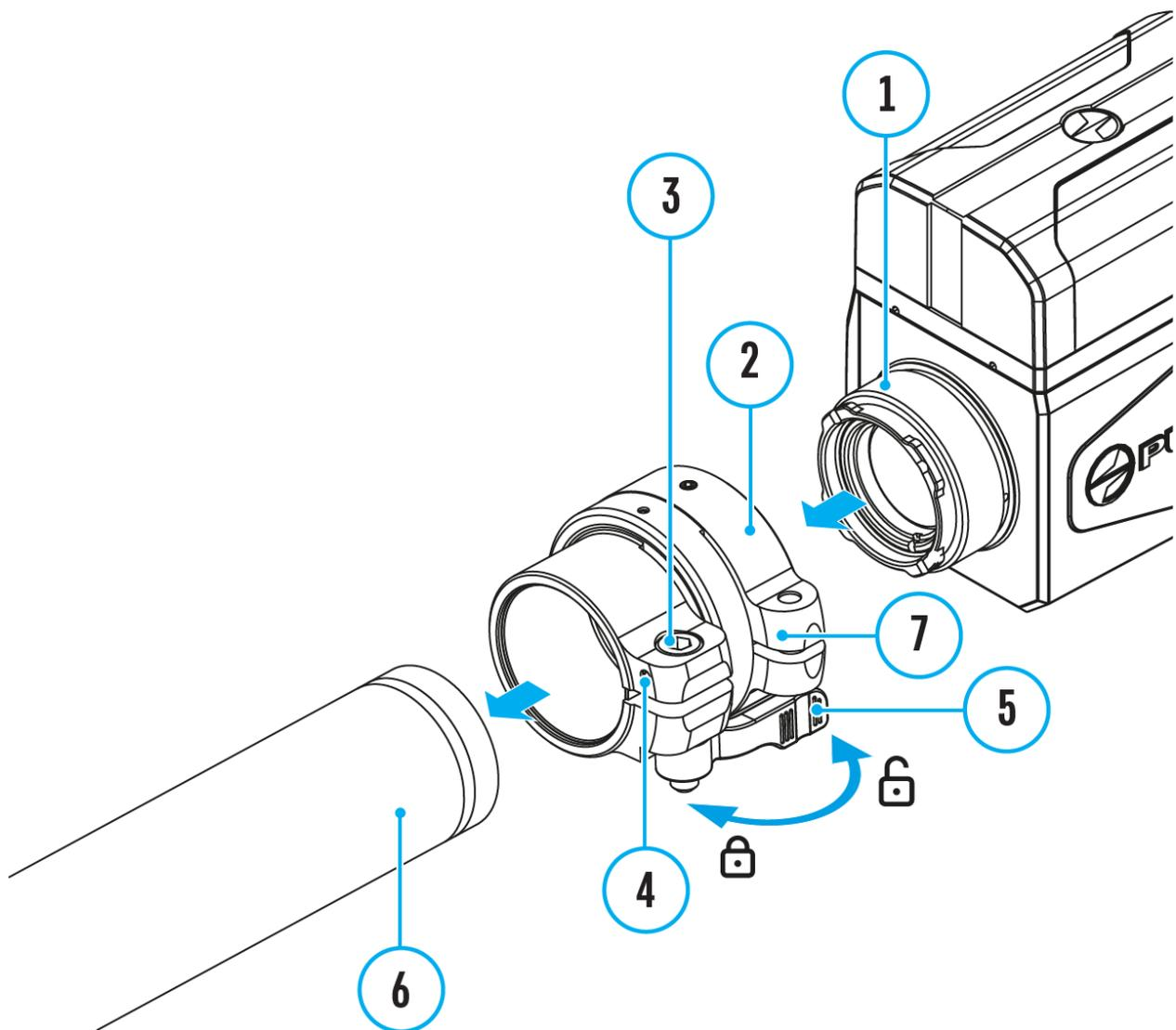
**Schritt 1. Montieren Sie den Adapter auf dem optischen Gerät**
