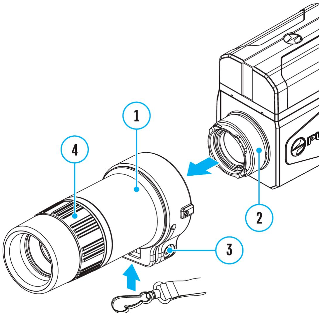
**1.** Richten Sie die Vorsprünge des Monokulars (**1**) an der Seite des Objektivs auf die Nuten der Halterung (**2**) des Wärmebildmoduls aus.
